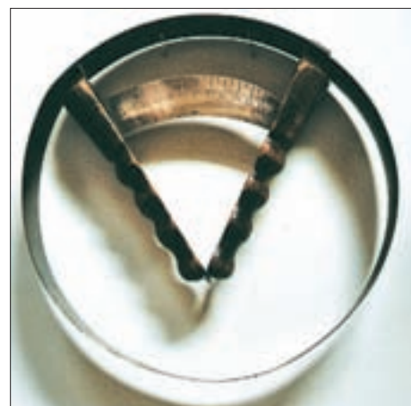
Messgerät zum Feststellen der Hutgröße.
