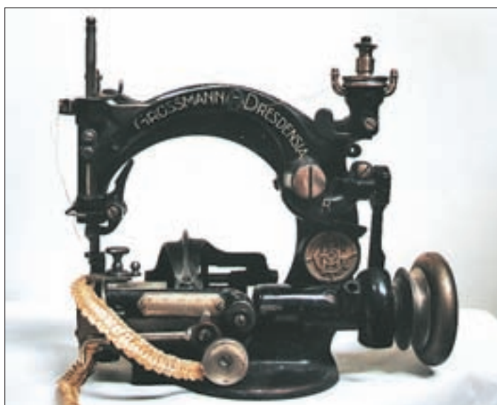
▲ Spezialbügeleisen zum Bügeln des Hutrandes. Maschine zum Vernähen der Strohgeflechte zu Hüten. ►
