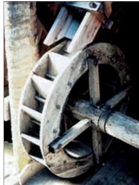
Das „Kumpfrad“ für die Kappsäge. – Der Antrieb der beiden anderen Sägen erfolgt über „Federräder“, weil sie mehr „Wasserkraft“ brauchen als jene.
