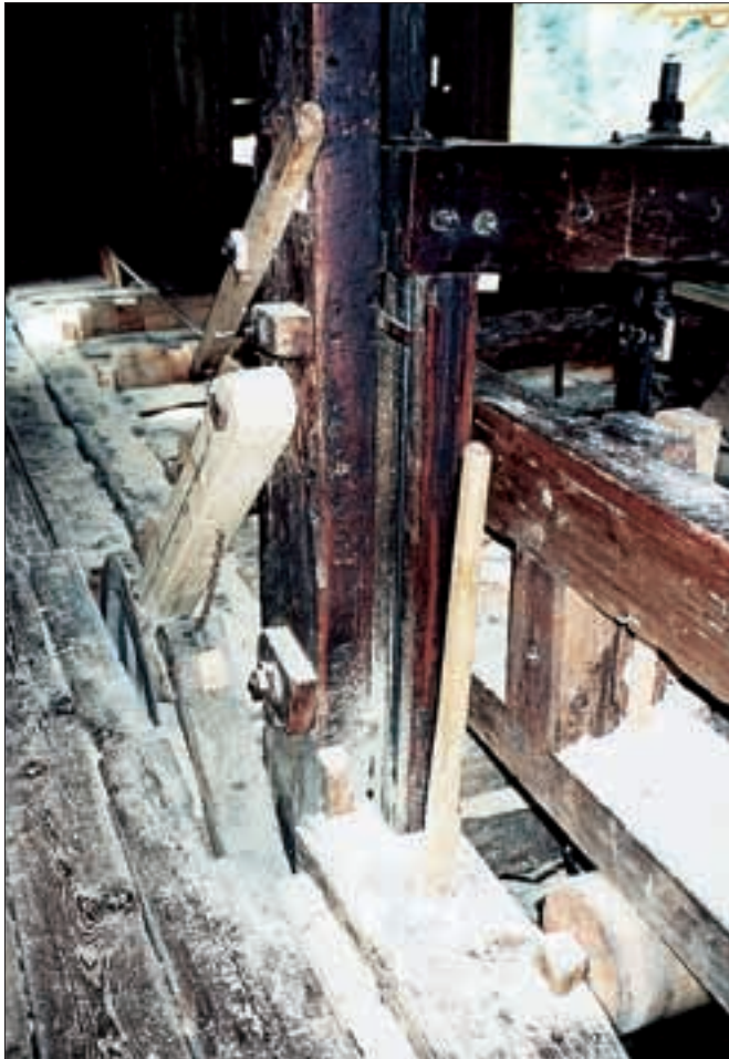
Die Gattersäge mit dem „Schubwerk“ (l.). – Vor dem Gatter steckt griffbereit die „Hebetatze“.
